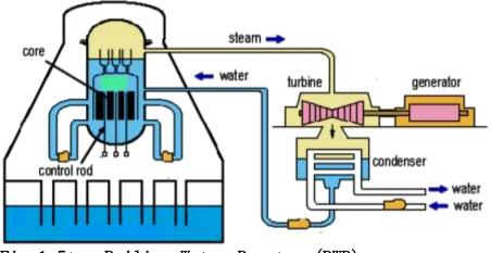
Fig. 1. 5: Boiling-Water Reactor (BWR)
