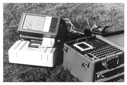
Fig. 4.1: Enhancement Seismographs
